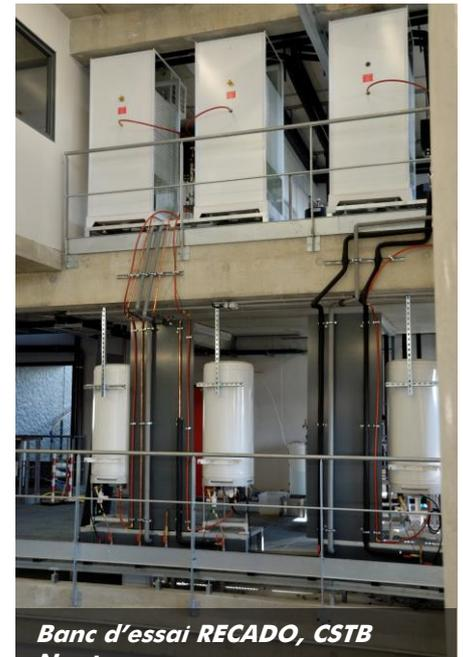
Le CSTB teste les trois montages possibles (ballon, mitigeur, mixte). Gecko a été testé suivant ce protocole en Novembre 2020 par le CSTB Nantes, avec les résultats suivants :
